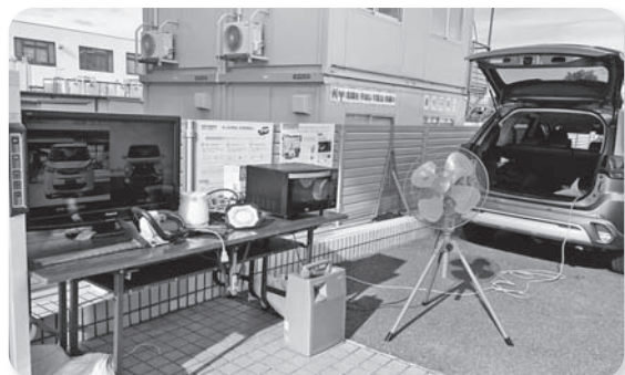
災害支援車から電気を送っている様子
