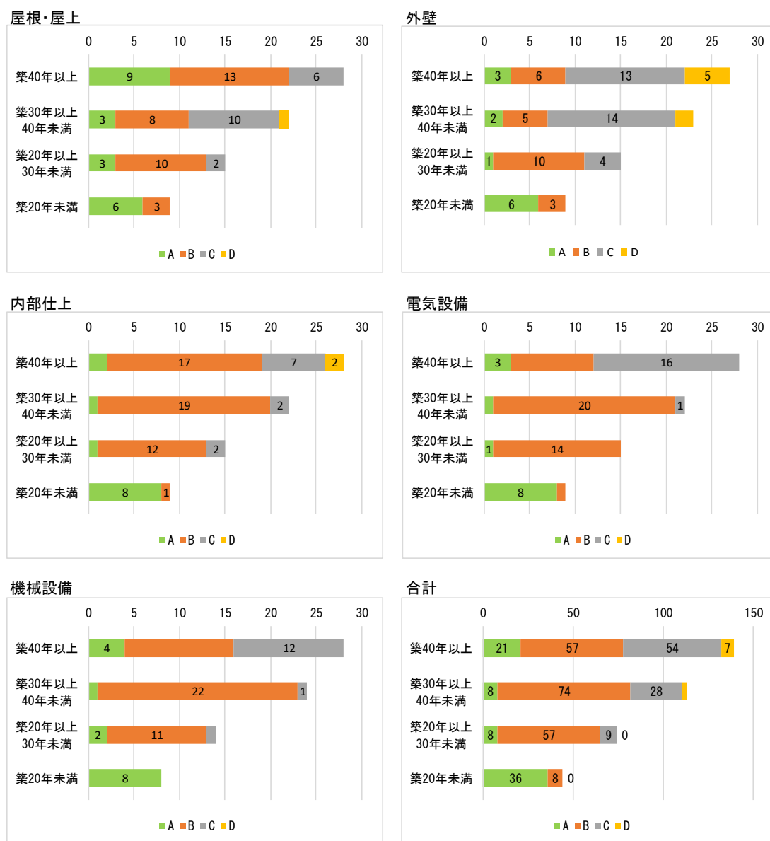
図表 16 部位別築年数別劣化状況
