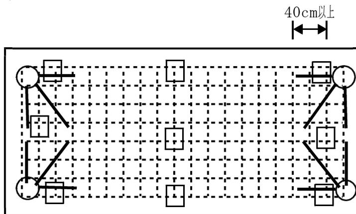
四隅に柱補強筋をたてる。(配筋D10・3本以上・支柱の太さは、150mm以上)
