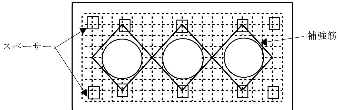
※縦筋共：D10以上・200mmピッチ・開口部に補強筋
